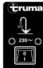
Placer le commutateur sur la pièce de commande en position „1“. La lampe-témoin signale que l'appareil est en service.
